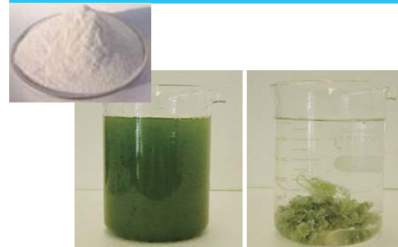
無機系凝集剤処理
