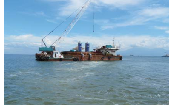
夏場の貧酸素水塊の発生抑制 (フォームジェット+濃縮酸素)
